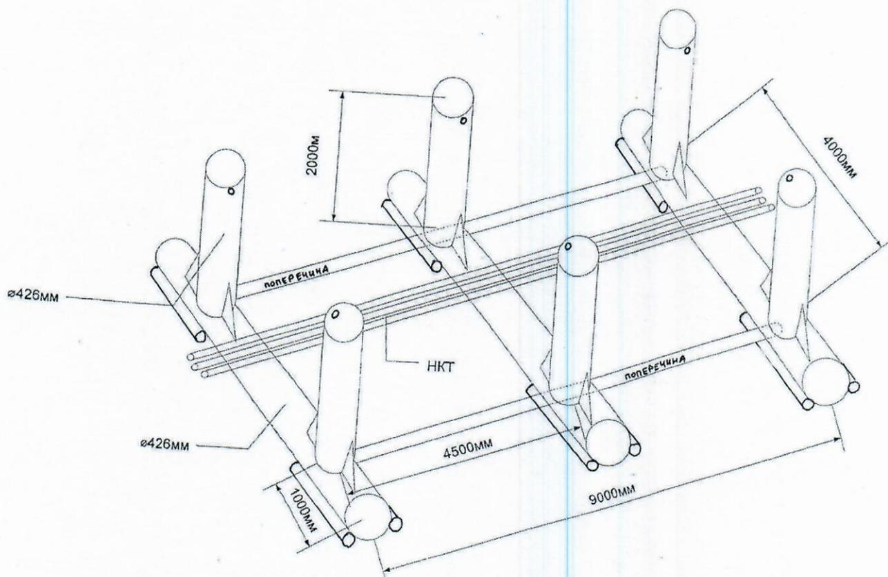
Назначение – хранение насосно-компрессорных труб, обсадных колонн, нефтепроводных труб.
