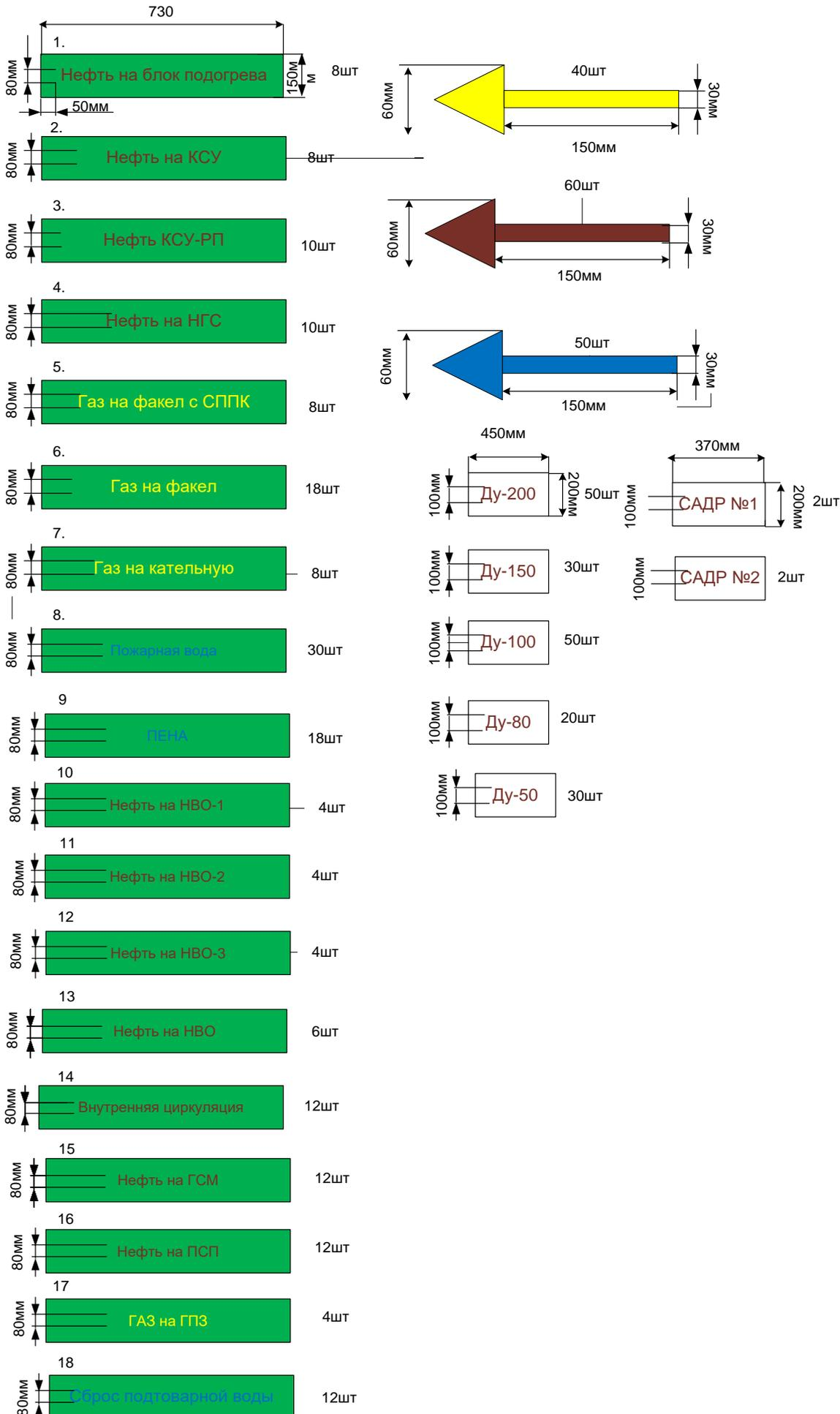
Схема (приложение №1): Наклейка для маркировки оборудования.
