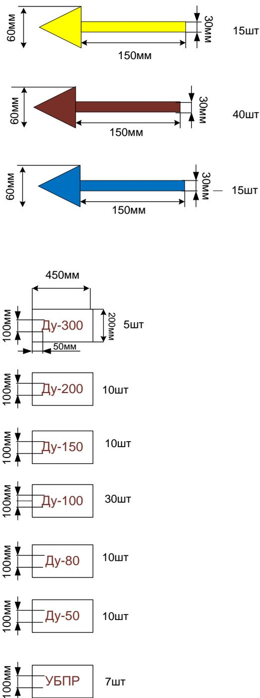
Схема( приложение №1): Наклейка для маркировки оборудования.
